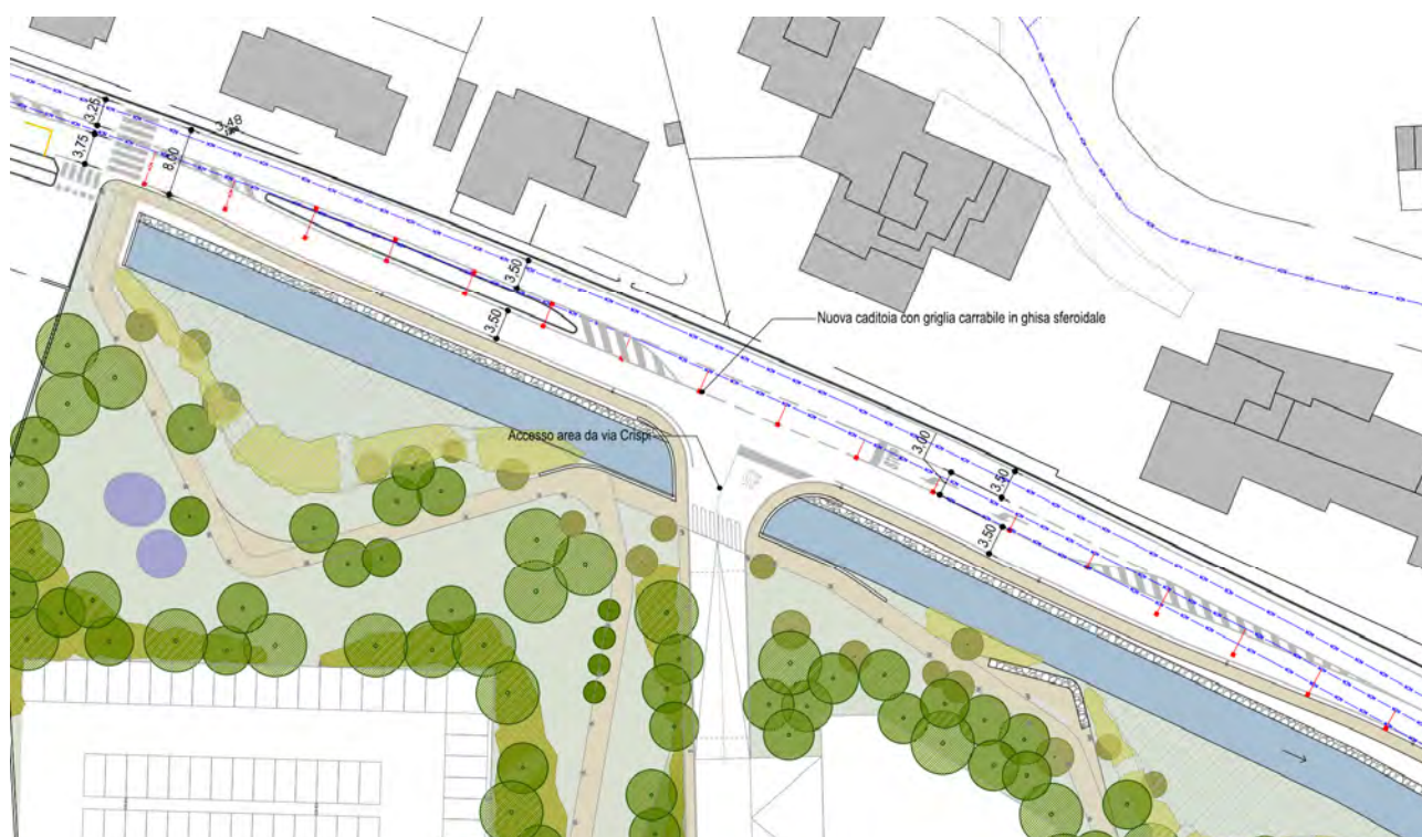
Figura 51 estratto tavola adeguamento reti tecniche – posizionamento delle nuove caditoie su via Crispi
